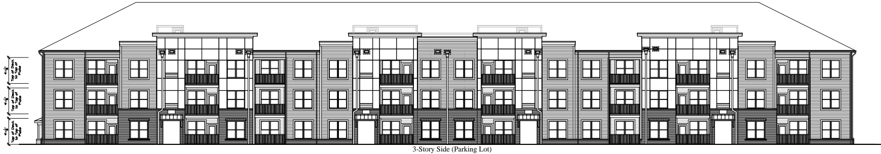
3 North Elevation (Building 2 & 3) Scale: \frac{3}{32}'' = 1'-0''
