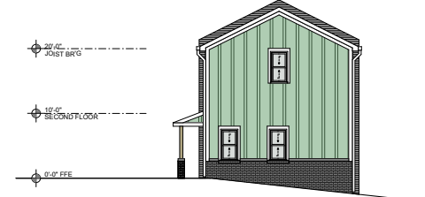
4 TOWNHOME SIDE ELEVATION A1.1 SCALE: 1/8" = 1'-0"
